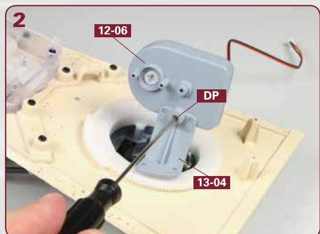
Befestigen Sie die rechte Getriebehalterung **13-04** mit einer Schraube **DP** am Getriebegehäuse **12-06**, wie es das Foto zeigt.
