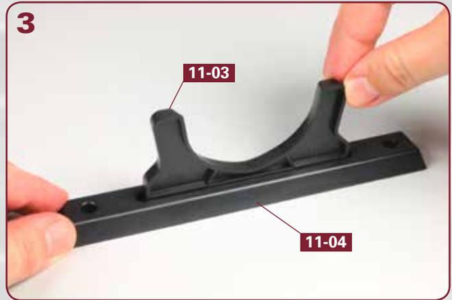
Fügen Sie die Zapfen der Halterung **11-03** in die Bohrungen des zweiten Trägers **11-04** ein.
