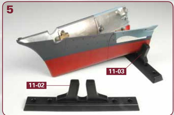
Das Foto zeigt die bis zum Anschlag durchgeschobene Halterung **11-03**. Stellen Sie die Halterung **11-02** bereit.
