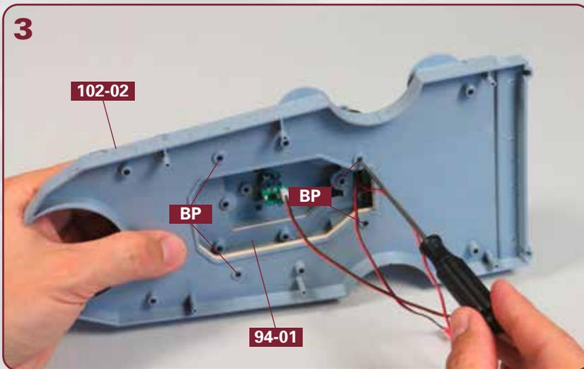
Befestigen Sie die Hauptstruktur der achteren Aufbauten **94-01** mit den vier Schrauben **BP** am achteren Aufbaudeck **102-02**.
