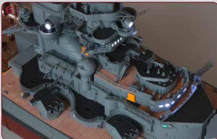
Drücken Sie auf dem Tester **18-01** den Knopf „S3“ (Detailbild), gehen alle LED der vorderen Aufbauten an. Diese Ansicht von Steuerbord-vorn zeigt das Licht der Kommando- und Admiralsbrücke und von zwei der fünf Scheinwerfer sowie das grüne Seitenlicht.
