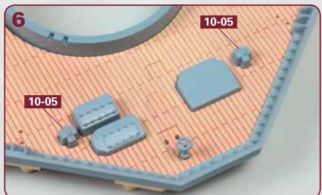
Nehmen Sie die beiden Oberlichter **10-05**. Versehen Sie deren Unterseiten mit etwas Sekundenkleber und setzen Sie sie in den entsprechenden Vertiefungen des Oberdeckabschnitts **10-01** auf.
