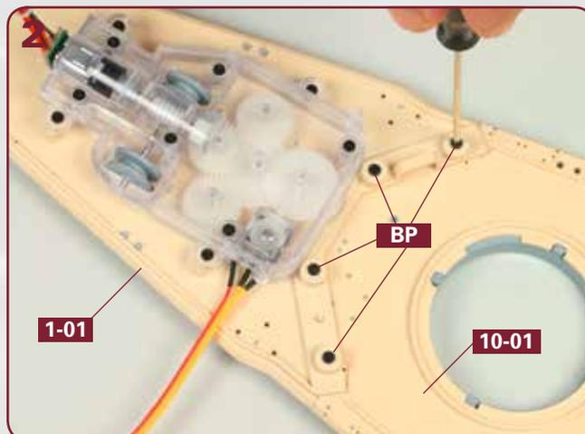
Platzieren Sie die Vertiefungen von **1-01** exakt über den Zapfen an der Unterseite von **10-01**. Fixieren Sie die beiden Oberdeckabschnitte aneinander, indem Sie die vier Schrauben **BP** eindrehen.
