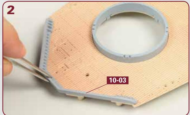
Fügen Sie den Wellenbrecher **10-03** in die Aussparungen ganz vorne am Oberdeckabschnitt **10-01** ein. Die Verwendung einer Pinzette bei diesen Schritten erlaubt besonders sauberes Arbeiten.
